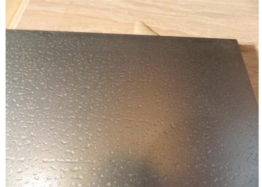
3. Lassen Sie den Edellosterzeuger ca. 8- 12 Stunden einwirken. (Abb. Links ca. 4 Stunden nach dem Auftragen des Edellosterzeugers, Abb. Rechts ca. 8 Stunden nach dem Auftragen des Edellosterzeugers)
