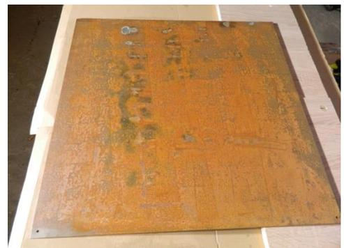
4. Besprühen Sie die noch nicht fertige Edellostpatina „druck los“ mit Wasser (Pump-Spray, Schwamm usw.)
